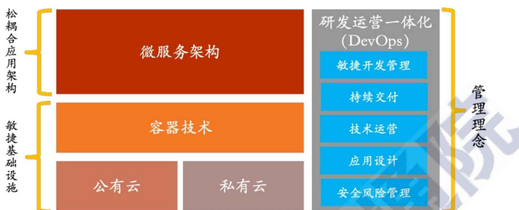
图 13 云原生关键技术架构图
